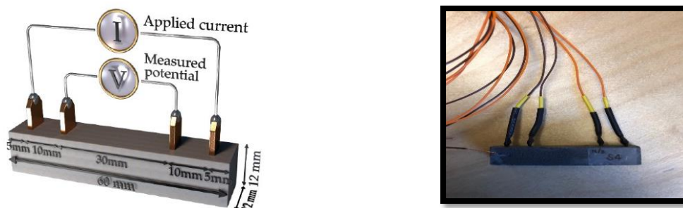
Figur 1. Mätprincip och färdig att installera prototypsensor.
